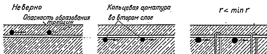
Рис.1.6 - 6. Предотвращение откола защитного слоя бетона при кольцевой арматуре
