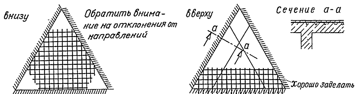
Рис. 2.1 - 42. Армирование равнобедренных треугольных плит с жестко защемленными краями
